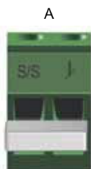
36. ábra Digitális bemenet a vezérlőegységben A: Csatlakozódugós változatok B: Kapocsléces változatok
