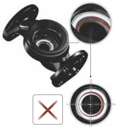
14. ábra Nem megfelelően középre igazított tömítések
